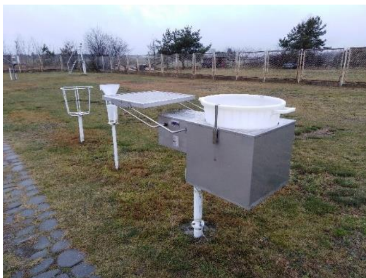
Rysunek 4.2 Automatyczny kolektor zbierania opadów mokrych z otwartą pokrywą podczas trwania opadu, w tle mały kolektor zbierania opadu do pomiaru pH [fot. J. Biszczuk-Jakubowska]
