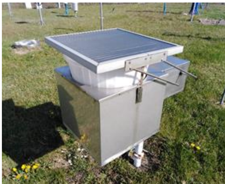
Rysunek 4.3 Automatyczny kolektor zbierania opadów mokrych z zamkniętą pokrywą podczas braku opadu [fot. J. Biszczuk-Jakubowska]
