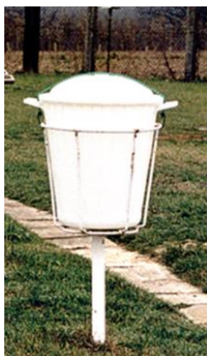
Rysunek 4.4 Zapasowy kolektor manualny [fot. z archiwum IMGW-PIB]
