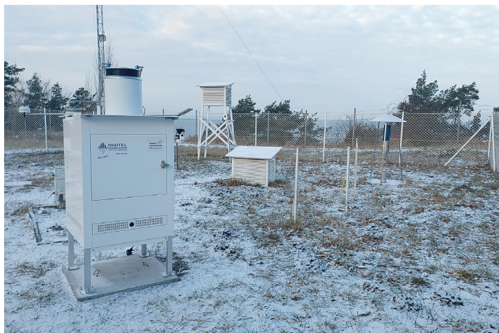
Kolektor opadu mokrego na stacji na wyspie Wolin (fot. GIOŚ)
