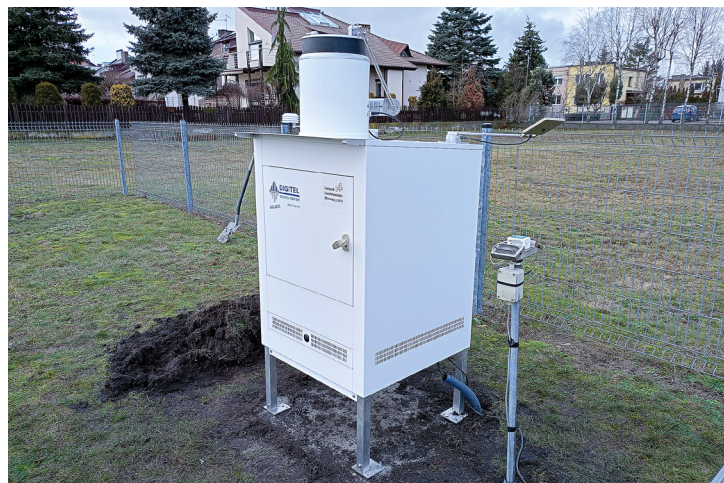
Kolektor opadu mokrego na stacji w Toruniu (fot. GIOŚ)
